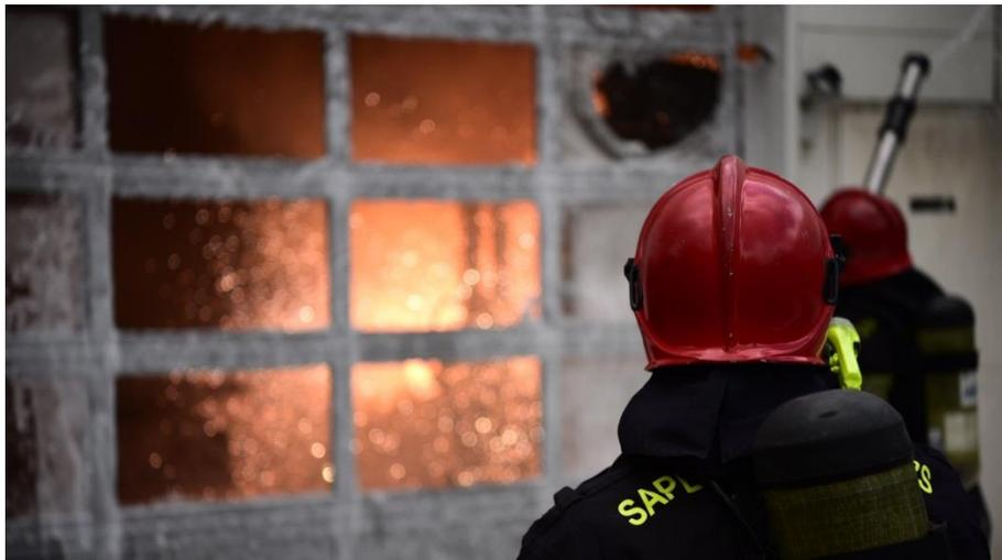
Lors de l'emballement des batteries des particules incandescentes visibles sur la photo sont projetées (**température comprise entre 1500 et 2000°C**).
